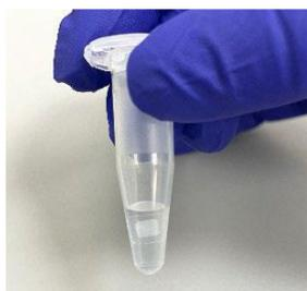
图 7. Seeker 芯片浸没在杂交反应混合液中
