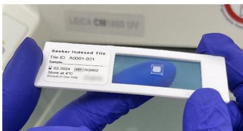
图 6. 组织切片精准贴附至 Seeker 芯片上的示例
